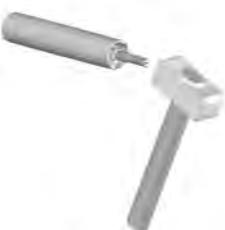
Piantare il perno all'interno del profilo servendosi di un martello, avendo cura di inserirlo fino in battuta e senza danneggiare le superfici di calettamento dei cuscinetti
