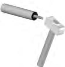
Piantare il perno all'interno del profilo servendosi di un martello, avendo cura di inserirlo fino in battuta e senza danneggiare le superfici di calettamento dei cuscinetti
